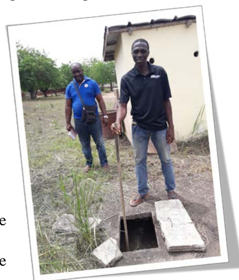
Mesure de la hauteur de boue, moins de 5 cm
